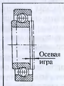
Рис. 49. Осевая игра в подшипнике шариковом радиальном однорядном
